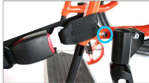
Abbildung 146: Symbol für vordere Befestigung und Umschlaufung des Rollstuhls vorne
