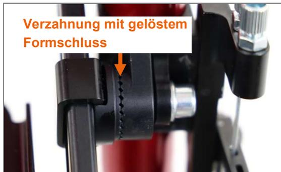
Abbildung 104: Verzahnung am Fußbügelspanner, gelöster Formschluss
