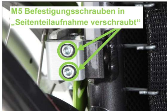
Abbildung 51: „Seitenteilaufnahme verschraubt“ mit Langlöchern und M5 Befestigungsschrauben am Grundkörper der Seitenteilaufnahme (Ansicht von unten)
