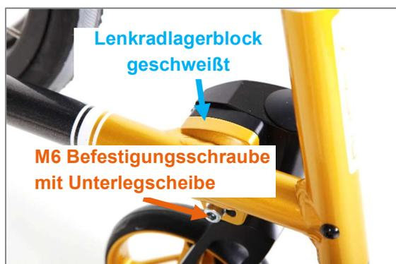
Abbildung 83: M6 Befestigungsschraube an der Rahmeninnenseite mit Unterlegscheibe
