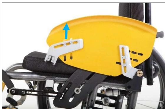
Abbildung 41: Kleiderschutz vorne aus der „Seitenteilaufnahme verschraubt“ gezogen (Ansicht ohne Antriebsrad)
