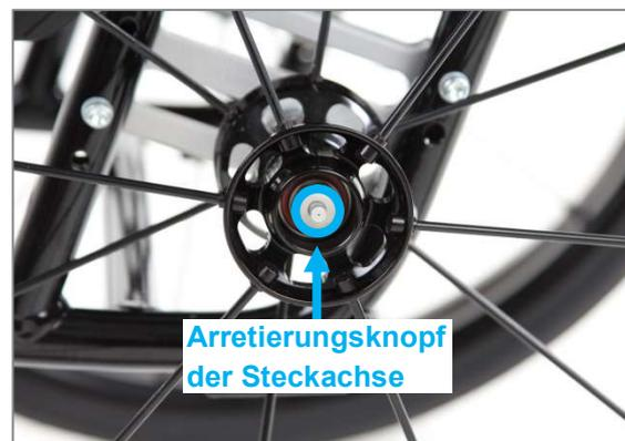
Abbildung 54: Arretierungsknopf der Steckachse in der Mitte der Radachse
