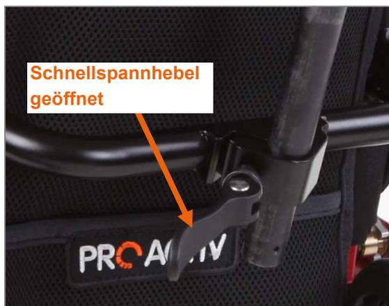
Abbildung 134: Geöffneter Schnellspannhebel
