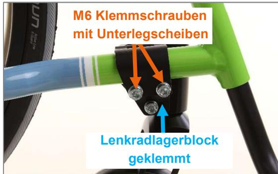
Abbildung 85: M6 Klemmschrauben beim geklemmten Lenkradlagerblock
