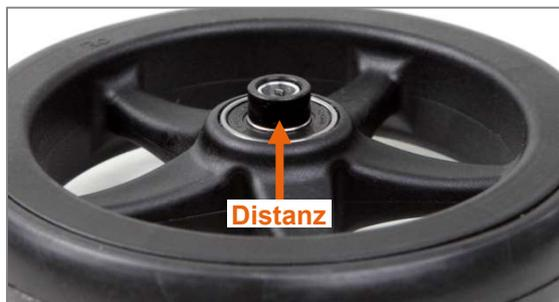
Abbildung 75: Distanz am Lenkrad
