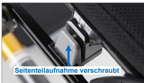
Abbildung 40: „Seitenteilaufnahme verschraubt“ (Ansicht ohne Kleiderschutz)
