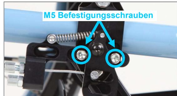
Abbildung 123: M5 Befestigungsschrauben
