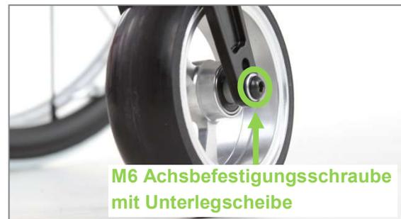
Abbildung 72: M6 Achsbefestigungsschraube der Lenkradachse (Ansicht von Produktaußenseite)
