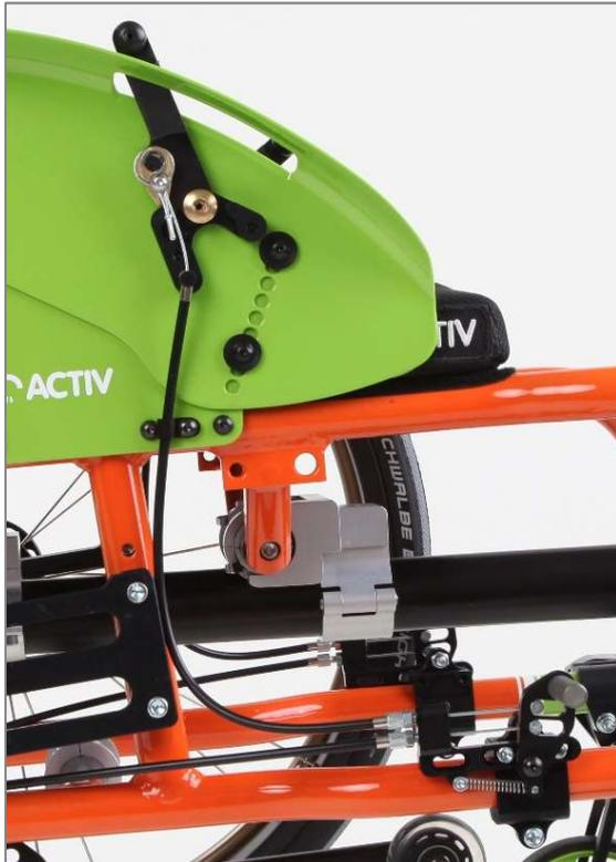
Abbildung 122: Kniehebelbremssystem mit Bremsbedienung oben im Kleiderschutz integriert
