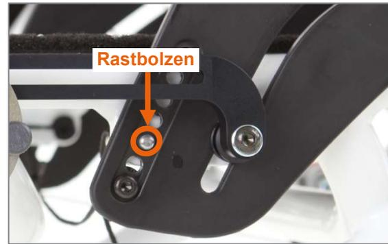
Abbildung 21: Rastbolzen greift in das Arretierloch im Seitenteil (Ansicht von Produktaußenseite, ohne Kleiderschutz)
