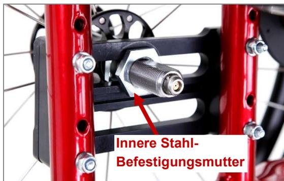
Abbildung 5: Innere Stahl-Befestigungsmutter (Ansicht von Produktinnenseite)
