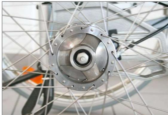
Abbildung 118: Trommelbremse
