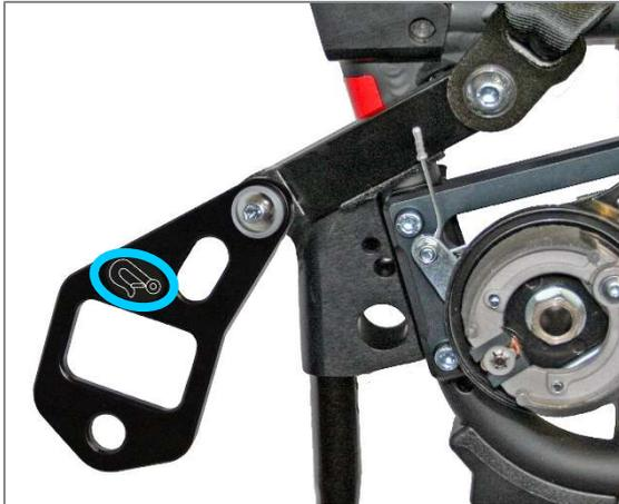
Abbildung 144: Kraftknotenbindung am hinteren Rahmen mit Gurtöse für Retraktor hinten und Beckengurt
