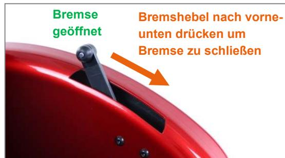
Abbildung 120: Bremse geöffnet; Bremshebel nach vorne-unten drücken um Bremse zu schließen
