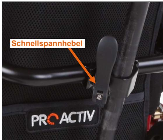
Abbildung 133: Geschlossener Schnellspannhebel
