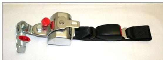
Abbildung 138: Retraktor vorne „Semi-Automatik“
