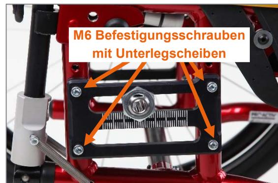
Abbildung 7: M6 Befestigungsschrauben der Radplatte (Ansicht von Produktaußenseite, Antriebsrad abgenommen)
