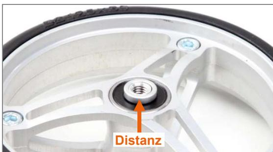
Abbildung 71: Distanz am Lenkrad
