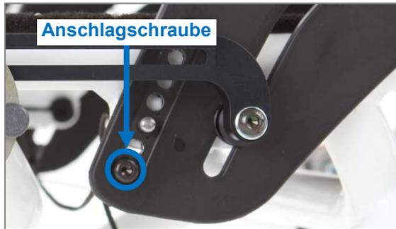
Abbildung 23: Anschlagschraube (Ansicht von Produktaußenseite)
