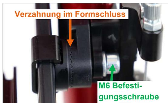
Abbildung 103: Verzahnung am Fußbügelspanner, im Formschluss
