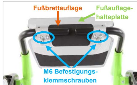
Abbildung 86: Fußstütze von unten
