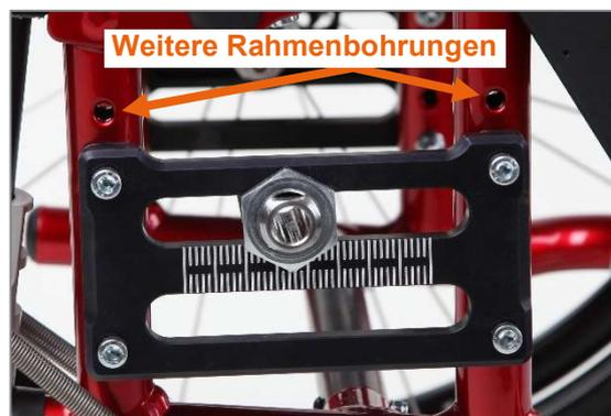
Abbildung 10: Rahmenbohrungen (Ansicht von Produktaußenseite, Antriehsrad abgenommen)
