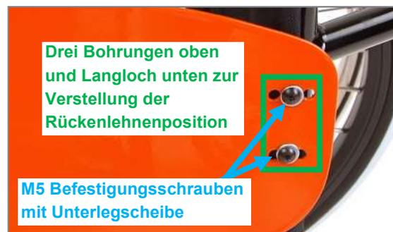
Abbildung 20: Verstellung der Rückenlehnenposition über Bohrungen im Seitenteil
