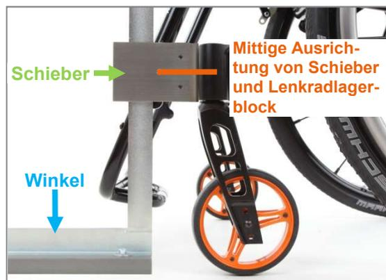
Abbildung 81: Überprüfung der Einstellung der Lenkradgabel-drehachsen
