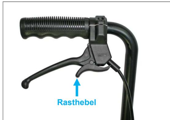
Abbildung 127: Bremsgriff an der Schiebevorrichtung mit Rasthebel
