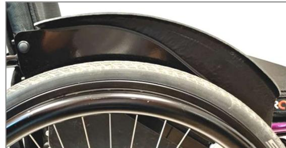
Abbildung 31. Kleiderschutz am Produkt angebracht (Ansicht mit Antriebsrad)
