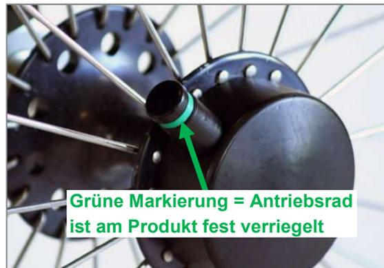
Abbildung 57: Tetra-Clip mit verriegelter Steckachse
