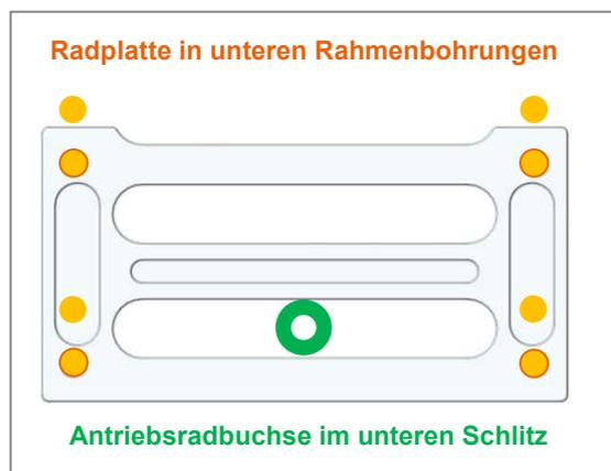
Abbildung 11: Beispielhafte Ausgangsposition zur Verstellung
