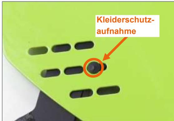
Abbildung 43: Kleiderschutzaufnahme
