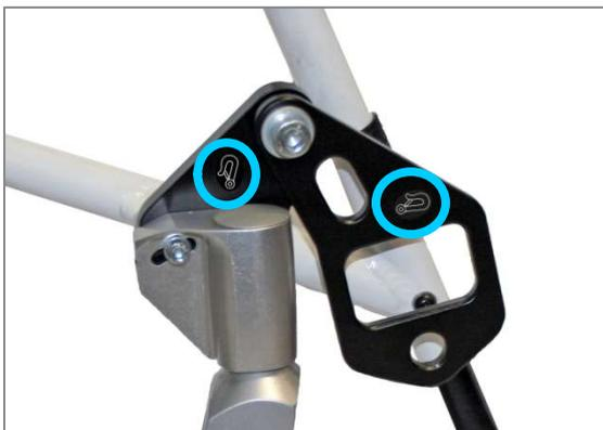
Abbildung 145: Lenkradlagerblockzwischenplatte mit Gurtöse für Retraktor vorne
