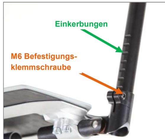
Abbildung 98: Einkerbungen und M6 Befestigungsklemmschraube zur Unterschenkellänge-Einstellung (Ansicht von hinten)
