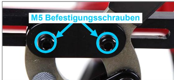
Abbildung 114: M5 Befestigungsschrauben an der Bremshalteschiene
