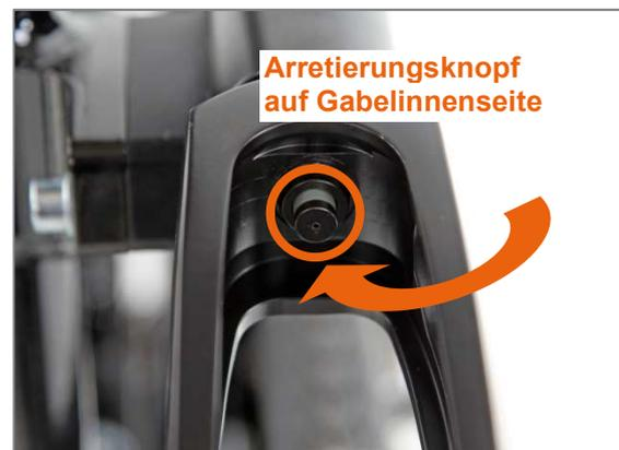
Abbildung 80: Lenkradgabel mit Steckachse und Arretierungsknopf
