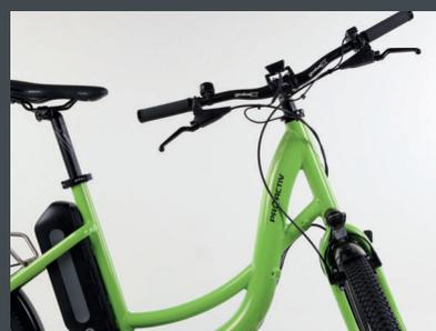
Der Lenkanschlag verhindert in Verbindung mit dem Zweibeinständer die Beschädigung der Lichtanlage und Bowdenzüge im abgestellten Zustand.
