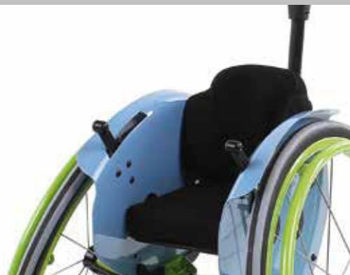
La leva del freno si trova a portata di mano del bambino. La spondina paraspruzzi segue il passaruota a distanza omogenea.
