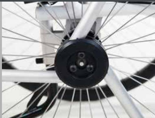
Per una facile maneggevolezza, le ruote motrici sono rimovibili grazie all'asse ad innesto. Il lato motore si può cambiare facilmente spostando l'innesto delle ruote.
