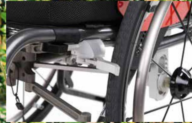
Il »freno di stazione integrale« è comodo da usare. Con il freno aperto, questo rimane ribaltato completamente sotto il telaio, lasciando libero spazio di movimento alle mani e alle dita.
