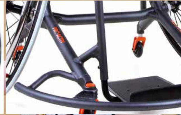
L'esclusivo equipaggiamento con monocomando e piastra avvitata consente una regolazione del punto di ribaltamento e della regolazione in altezza di ca. 1 - 2 cm.
