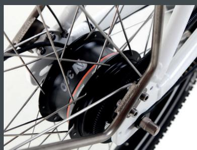
Die Nabenschaltung ist stufenlos und lässt das Kettenspringen sowie laute Nebengeräusche beim Schalten verschwinden.
