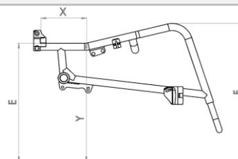
Für die Konstruktion gelten die Maßtoleranzen gemäß DIN EN ISO 13920 (Maße in mm)
