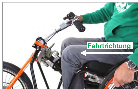
Abbildung 87: Bremse des Produkts drücken und mit den Greifringen in Richtung des Produkts fahren bis Entriegelung erfolgt
