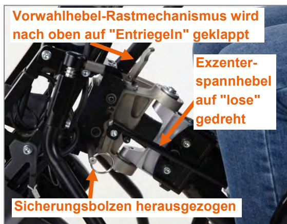
Abbildung 75: Vorbereitung für Abkopplung
