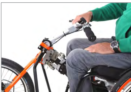
Abbildung 82: Eingehängter Einhängebolzen im Einhängemaul am Lenkkopf
