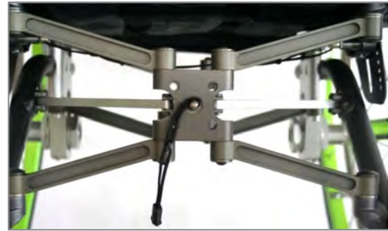
Abbildung 20: Position Auslöseschnur falsch, Bohrungen für Zentrierstifte unten links verdeckt
