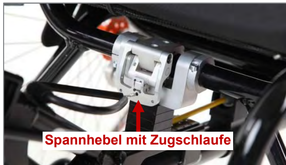
Abbildung 35: Spannhebel mit Zugschlaufe in geschlossener Position, betriebsbereit montierter Starrrahmenadapter
