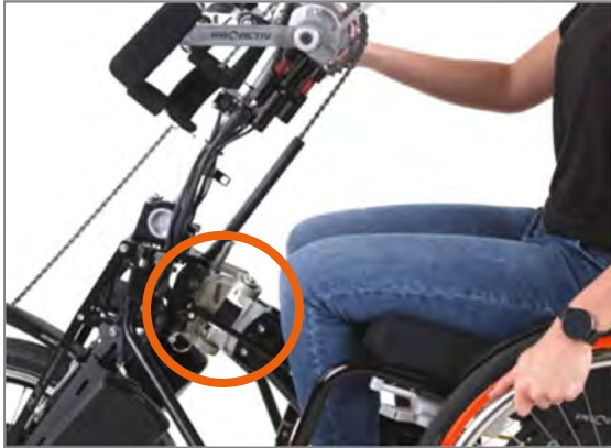
Abbildung 66: Einhängen des Einhängebolzens der Andockplatte im Einhängemaul am Lenkkopf
