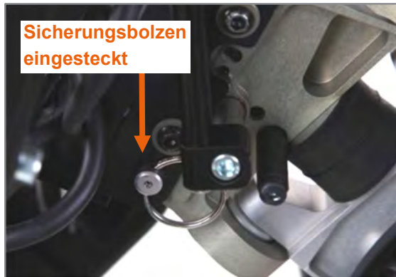
Abbildung 70: Adapter betriebsbereit adaptiert
