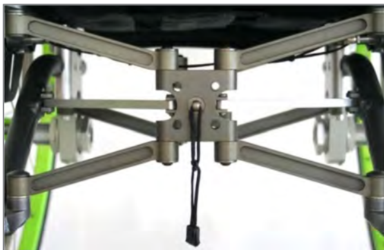
Abbildung 19: Position Auslöseschnur richtig, Bohrungen für Zentrierstifte frei
