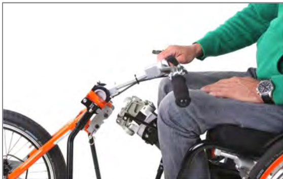
Abbildung 81: Einhängen des Einhängebolzens der Andockplatte im Einhängemaul am Lenkkopf
