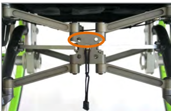
Abbildung 15: Bohrungen für Zentrierstifte
