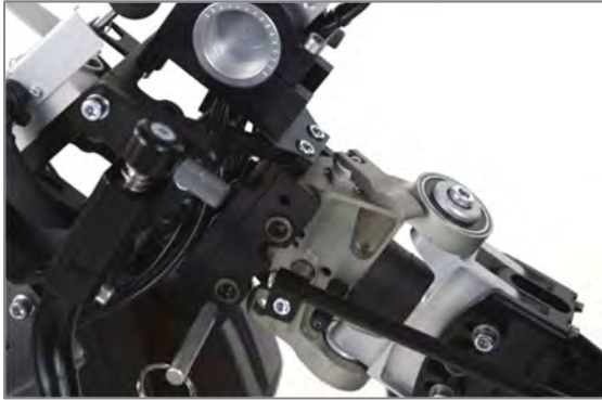
Abbildung 92: Eingehängter Einhängebolzen im Einhängemaul am Lenkkopf
