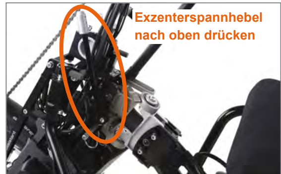
Abbildung 69: Exzentrerspannhebel wird auf "Spannen" gedrückt
