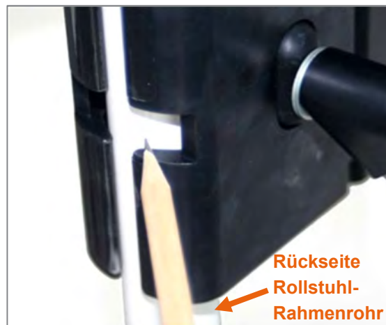
Abbildung 54: Anzeichnen der Position des Klemmhülsenanschlages an der Rahmenrohrrückseite des Rollstuhls
