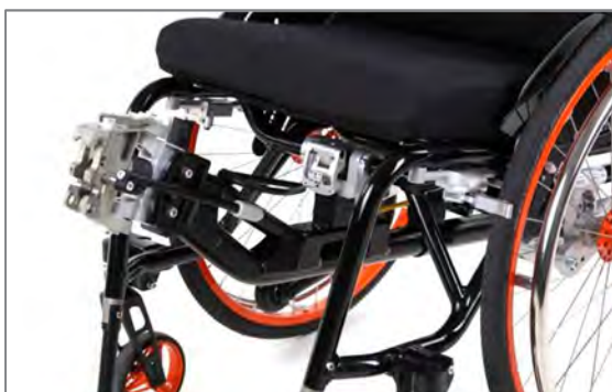
Abbildung 25: Zentraladapter an den Rahmenquerrohren
