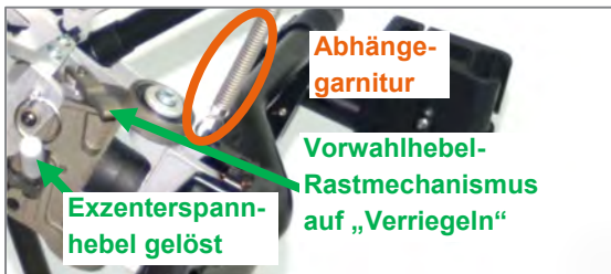
Abbildung 97: Einstellungen des Frontadapters zu Beginn der Adaption (Vorwahlhebel-Rastmechanismus und Exzentrerspannhebel)
