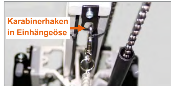
Abbildung 72: Abhängegarnitur bei Frontadapter, Karabinerhaken in Einhängeöse
