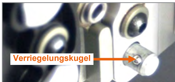
Abbildung 85: Sicherungsbolzen mit Verriegelungskugel, Verriegelungskugel auf der Außenseite der Andockplatte verriegelt
