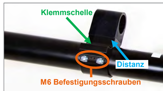
Abbildung 31: M6 Befestigungsschrauben zur horizontalen Positionierung der Zentrierzapfenaufnahme entlang des Adapterrohrs
