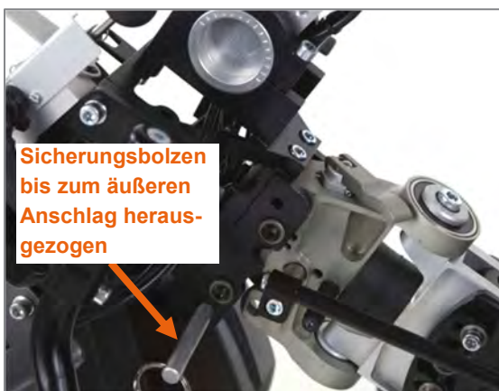
Abbildung 98: Einstellungen des Frontadapters zu Beginn der Adaption
