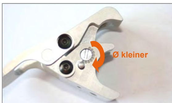
Abbildung 42: Drehen der Exzenterwelle entlang der Markierungspunkte (im Uhrzeigersinn kleinerer Ø, gegen Uhrzeigersinn größerer Ø)
