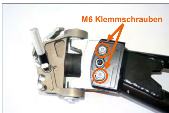
Abbildung 22: M6 Klemmschrauben am Lenkkopf
