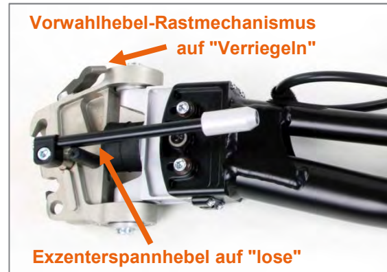
Abbildung 104: Adaptereinstellungen zu Beginn der Adaption
