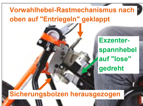
Abbildung 86: Vorbereitung für Abkopplung
