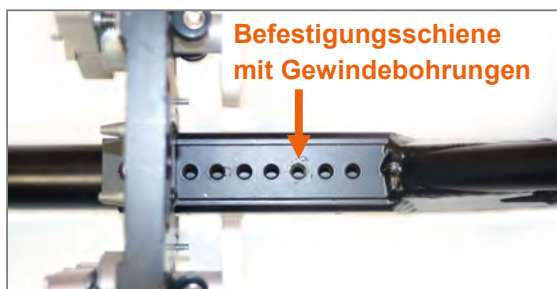
Abbildung 6: Positionierung der Verriegelungsplatte in 15 mm-Schritten
