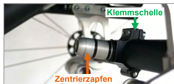
Abbildung 27: Zentrierzapfen mit Klemmschelle
