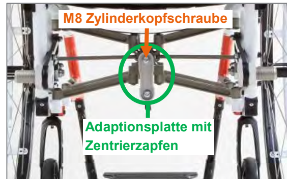
Abbildung 3: Faltmechanismus mit Adaptionplatte und Zentrierzapfen (Rollstuhl von hinten)
