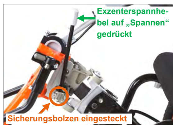
Abbildung 84: Adapter betriebsbereit adaptiert
