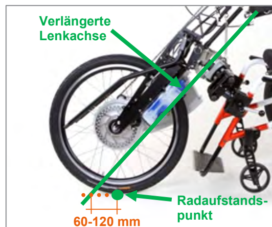
Abbildung 58: Nachlauf abhängig von der Winkeleinstellung des Lenkkopfes
