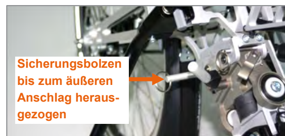
Abbildung 74: Einstellungen des Frontadapters zu Beginn der Adaption
