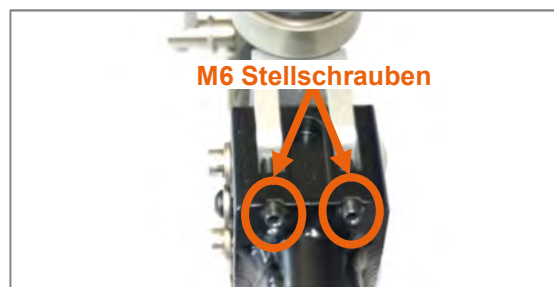
Abbildung 47: M6 Stellschrauben an der Lenkkopfanbindung anliegend
