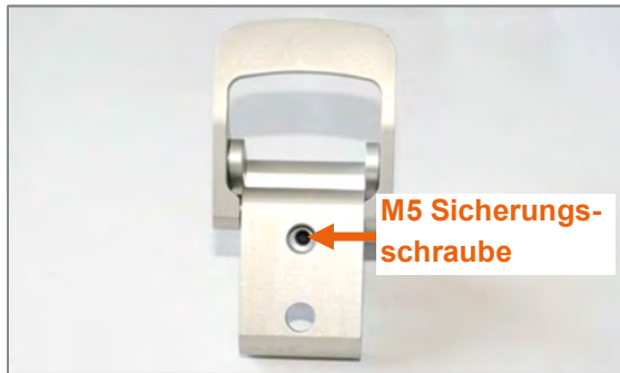
Abbildung 40: M5 Sicherungsschraube zum Fixieren der Exzenterwelle (von hinten)
