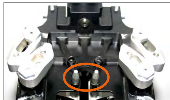
Abbildung 11: Zentrierstifte montiert für schmales Mittelteil
