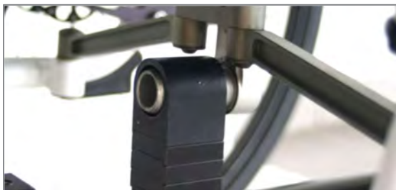
Abbildung 14: Zentrierzapfen mit aufgesteckter Zentrierzapfenaufnahme
