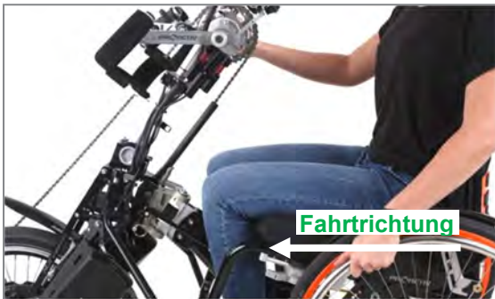
Abbildung 67: Fahren in Richtung des Produkts bis Verriegelungsgeräusch zu hören ist
