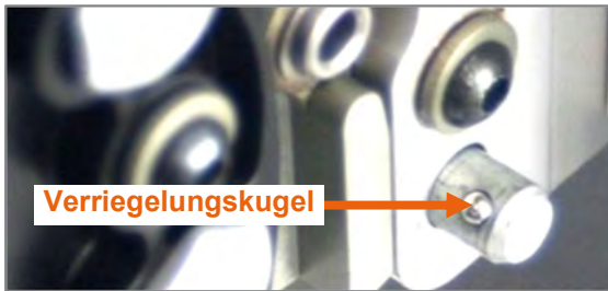
Abbildung 110: Sicherungsbolzen mit Verriegelungskugel, Verriegelungskugel auf der Außenseite der Andockplatte verriegelt
