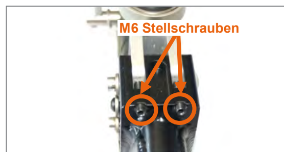
Abbildung 24: M6 Stellschrauben an der Lenkkopfanbindung anliegend
