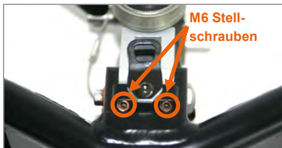
Abbildung 60: M6 Stellschrauben an der Lenkkopf anbindung anliegend
