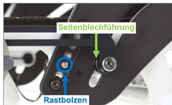
Abbildung 55: Rastbolzen greift in das Arretierungsloch im Seitenteil (Ansicht ohne Kleiderschutz)
