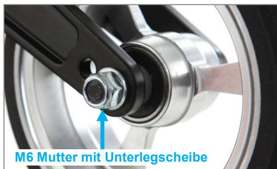
Abbildung 85: M6 Mutter der Lenkradachse (Ansicht von Produktinnenseite)
