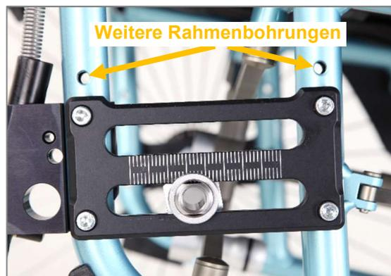
Abbildung 15: Rahmenbohrungen (Ansicht von Produktaußenseite, Antriehsrad abgenommen)
