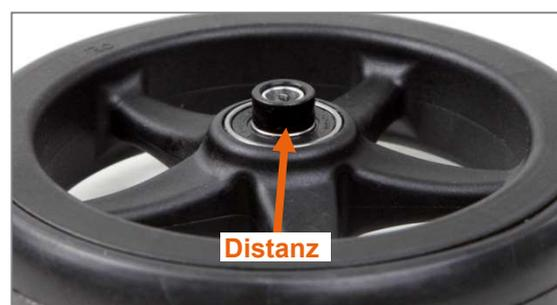
Abbildung 87: Distanz am Lenkrad
