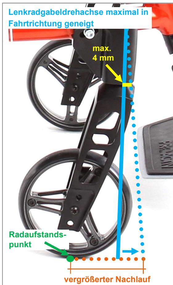
Abbildung 89: Nachlaufvergrößerung über Neigung der Lenkrahmdrehachse
