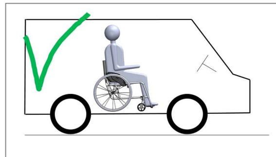
Abbildung 164: Richtige Ausrichtung des Rollstuhls im Fahrzeug
