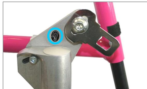
Abbildung 159: Lenkradlagerblockzwischenplatte mit Schlosszunge für Retraktor vorne
