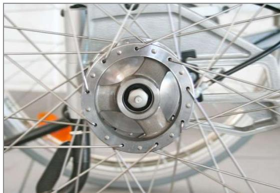
Abbildung 141: Trommelbremse
