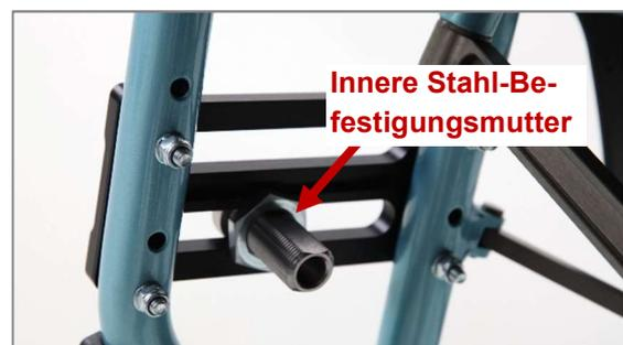
Abbildung 22: Innere Stahl-Befestigungsmutter (Ansicht von Produktinnenseite, Antriebsrad abgenommen)
