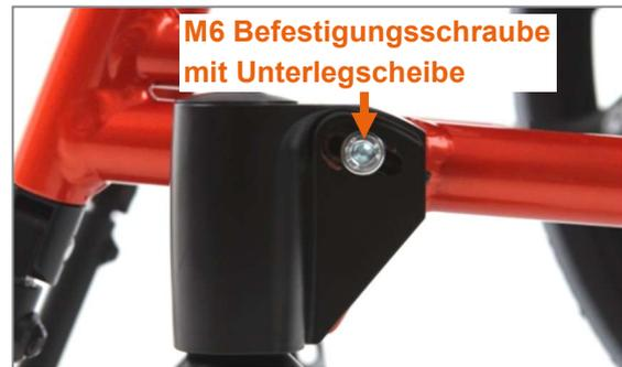
Abbildung 96: M6 Befestigungsschraube an der Rahmenaußenseite
