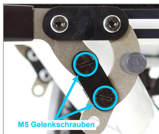
Abbildung 139: M5 Gelenkschrauben zur Einstellung der Betätigungskraft des Bremshebels
