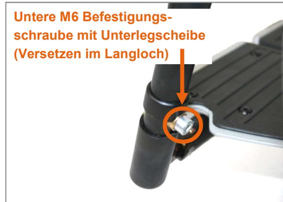
Abbildung 110: Untere M6 Befestigungsschraube (SW 5 mm) kann im Langloch positioniert werden
