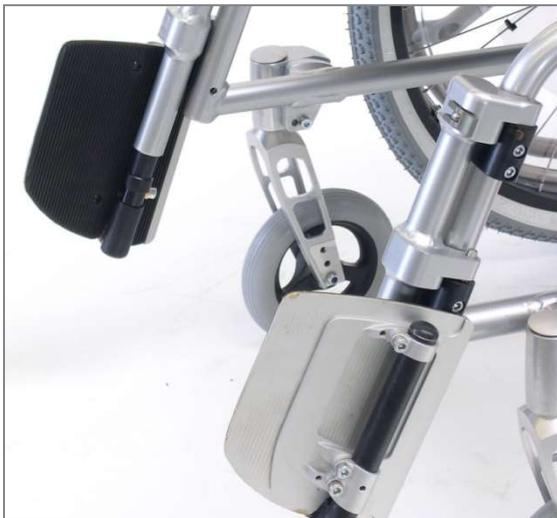
Abbildung 119: Beide Fußstützenteile hochgeklappt und nach außen gedreht
