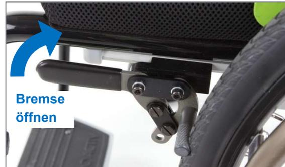
Abbildung 136: Bremse geschlossen; Öffnen erfolgt durch nach hinten-oben Ziehen des Bremshebels
