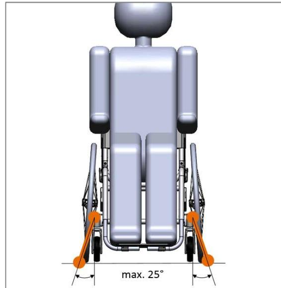
Abbildung 167: Verlauf der Retraktoren vorne mit maximalem Abspannwinkel und Anbindepunkten (Ansicht von vorne)
