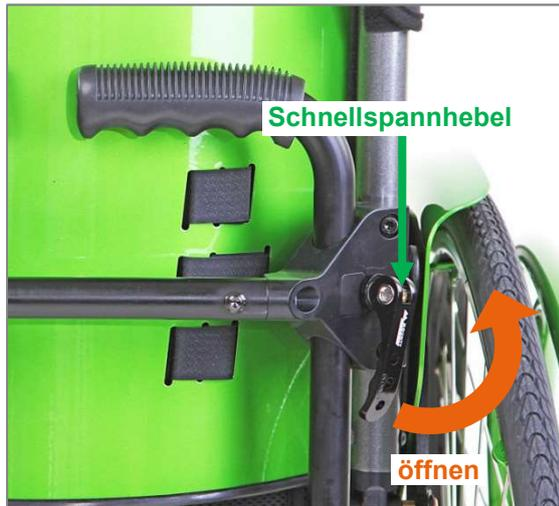
Abbildung 149: Geschlossener Schnellspannhebel
