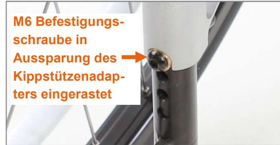
Abbildung 127: Kippstütze ordnungsgemäß eingerastet
