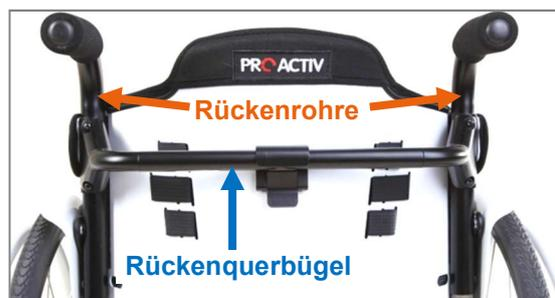
Abbildung 49: Rückenrohre und Rückenquerbügel
