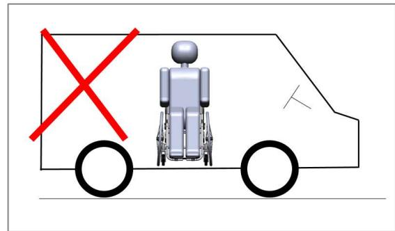
Abbildung 163: Falsche Ausrichtung des Rollstuhls im Fahrzeug
