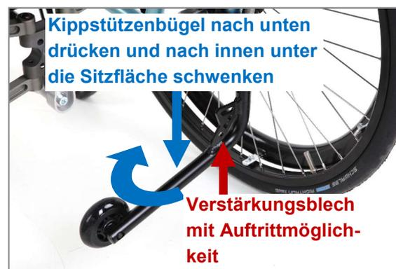
Abbildung 128: Kippstütze in Passivstellung bringen (Ansicht von hinten)
