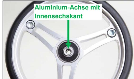
Abbildung 82: Lenkrad mit Aluminium-Innensechskant-Achse
