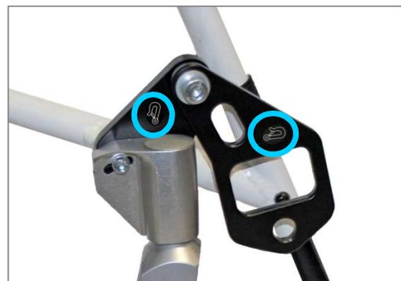
Abbildung 160: Lenkradlagerblockzwischenplatte mit Gurtöse für Retraktor vorne
