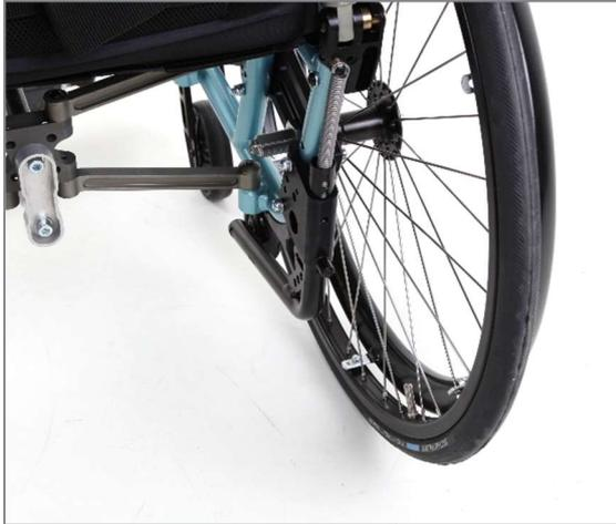
Abbildung 125: Passivstellung der Kippstütze (Ansicht von hinten)
