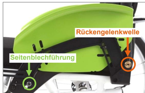
Abbildung 54: Kleiderschutz am Produkt angebracht (Ansicht ohne Antriebsrad)
