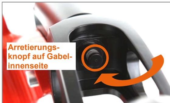
Abbildung 92: Lenkradgabel mit Steckachse und Arretierungsknopf
