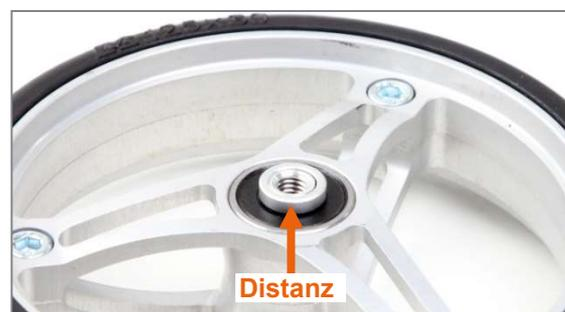
Abbildung 83: Distanz am Lenkrad
