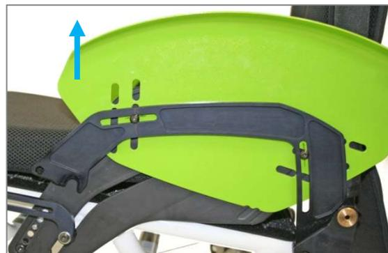
Abbildung 59: Kleiderschutz vorne aus der Seitenblechführung gezogen (Ansicht ohne Antriebsrad)
