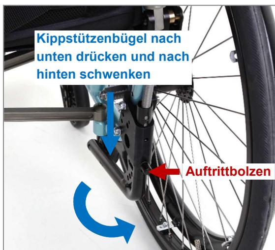
Abbildung 126: Kippstütze in Betriebsstellung bringen (Ansicht von hinten)
