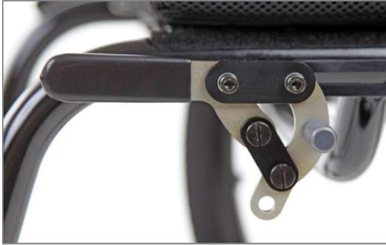
Abbildung 134: Kniehebelbremssystem mit Bremshebel Standard
