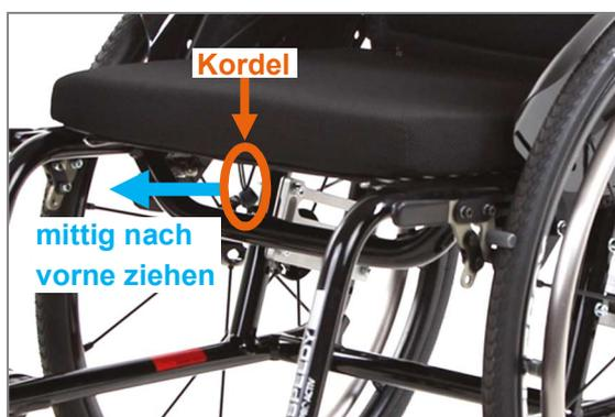
Abbildung 58: Kordel für die Betätigung der Rastbolzen
