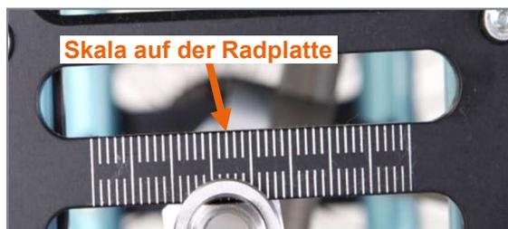
Abbildung 24: Skala auf der Radplatte
