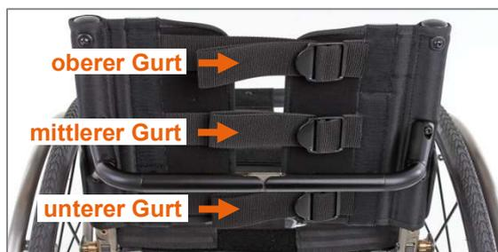
Abbildung 29: Gurtsystem der anpassbaren Rückenbespannung mit drei Gurten
