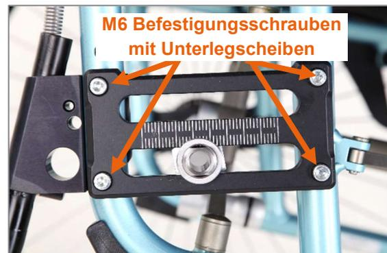
Abbildung 12: M6 Befestigungsschrauben der Radplatte (Ansicht von Produktaußenseite, Antriebsrad abgenommen)
