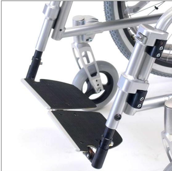
Abbildung 118: Fußstütze Swing away, in Standardposition
