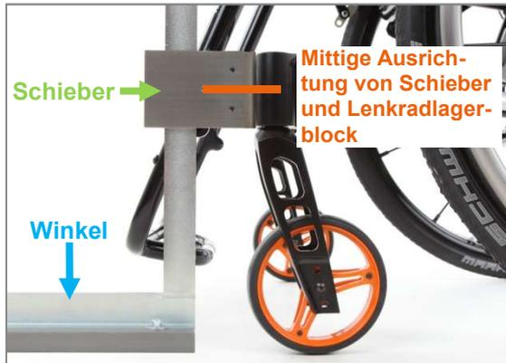
Abbildung 93: Überprüfung der Einstellung der Lenkradgabeldrehachsen
