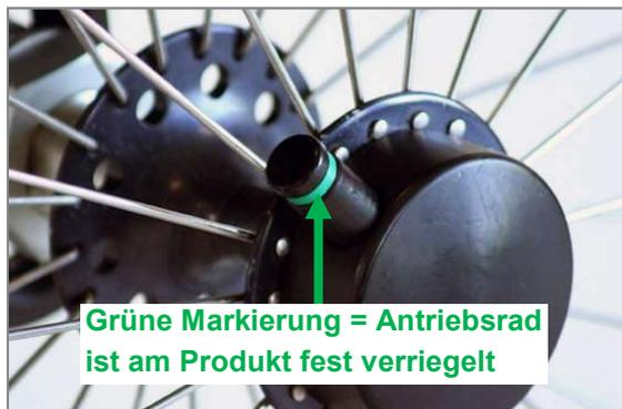
Abbildung 69: Tetra-Clip mit verriegelter Steckachse
