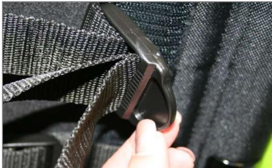
Abbildung 41: Schritt 5: Zurückführen des Gurtes durch die Spannöse um die geforderte "doppelte Durchführung" zu erhalten
